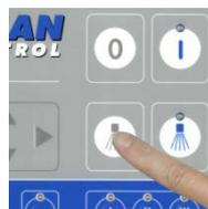
Durch Drücken der „Spülpause“-Taste wird der Spülbetrieb unterbrochen.
