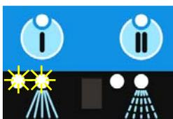
Sind in den Vorratsbehältern für Reiniger und/oder Klarspüler Sauglanzen mit Leitfähigkeitssonden eingebaut, so blinken bei einem leerem Vorratsbehälter die Leuchten der Tanktemperaturanzeige (links). Wird wieder Flüssigkeit in dem entsprechenden Vorratsbehälter erkannt, wird automatisch die Leeranzeige zurückgesetzt.
