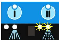
Ist die Patrone erschöpft, blinken die Leuchten der Boiler-temperaturanzeige (rechts). Diese Anzeige wird nicht automatisch bei Patronenwechsel zurückgesetzt. Dies muss manuell gemäß dem Beschrieb in der Kurzprogrammieranleitung erfolgen.
