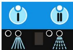
Dies kann ein Indiz dafür sein, dass der bauseitige Wasserzulauf geschlossen oder der Sieb im Zulaufventil verschmutzt ist. Der Waschtank kann nicht gefüllt werden.
