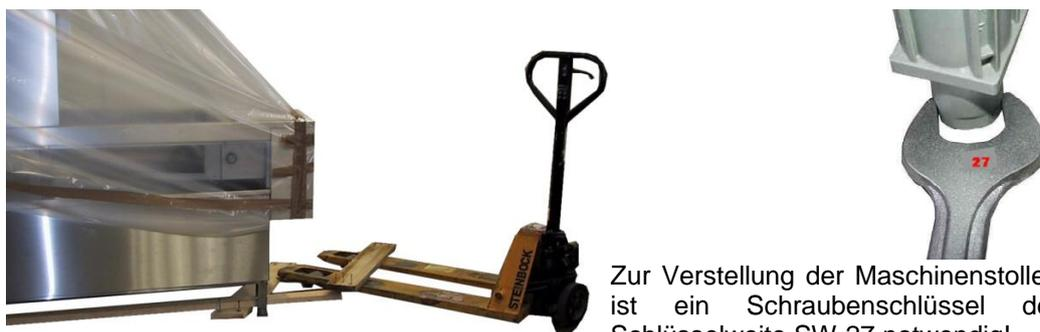
Zur Verstellung der Maschinenstollen ist ein Schraubenschlüssel der Schlüsselweite SW 27 notwendig!
