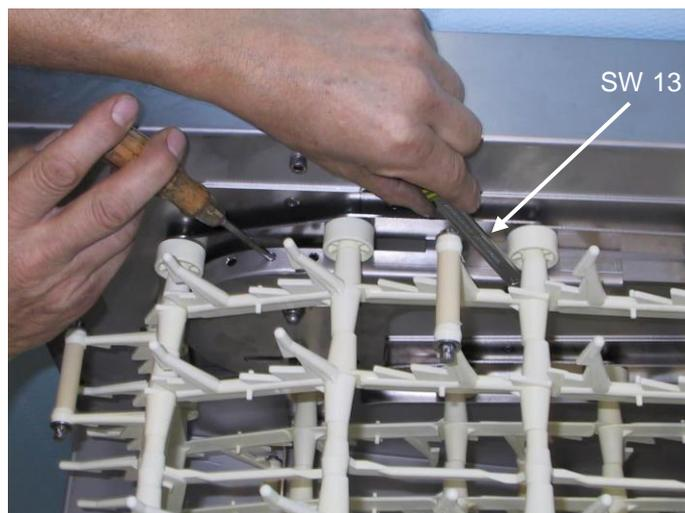
Das Maschinentransportband wird gespannt, indem man z.B. mit einem Schraubendreher die jeweilige Umlenkscheibe, wie im Bild gezeigt, in Einlaufrichtung bewegt. Im selben Moment kann man, die obere linke Feststellmutter mit einem Schraubenschlüssel SW 13 festziehen. Anschließend können die restlichen Muttern angezogen werden.
