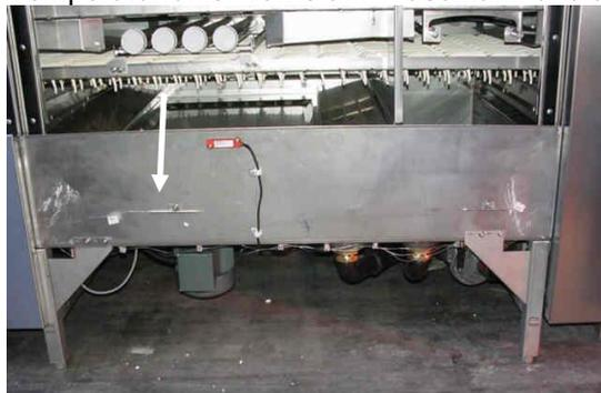
Temperaturfühler am Wassererwärmer:
