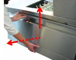
Entfernen Sie alle Verkleidungen im Einlauf- und Auslaufbereich
