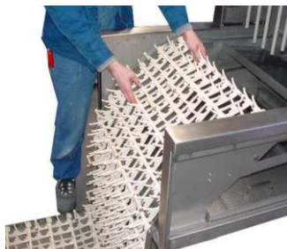
Der Bandanfang, (die Seite des Bandes in der sich die Bandstange befindet) wird von der Einlaufseite der Maschine auf die Laufschiene geschoben.
