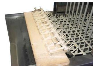
Das Bandstück wird soweit in die Maschine geschoben, bis sich das Ende kurz vor dem Einlauftunnel befindet.
