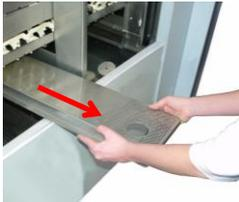
Entfernen Sie die Siebauflagen.
