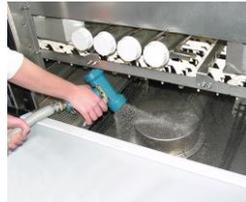
Reinigen Sie den Tankinnenraum mit einem Wasserschlauch.
