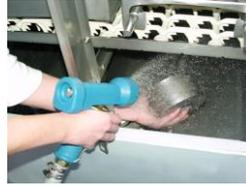
Entfernen Sie den Pumpenansaugsieb und reinigen Sie diesen.
