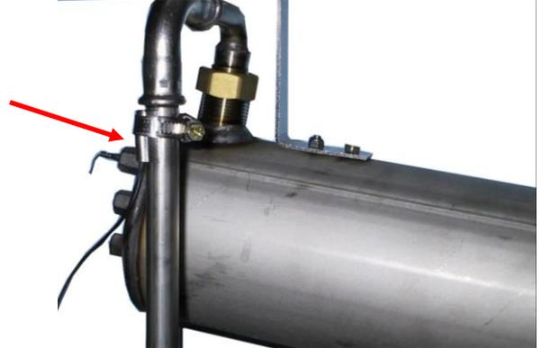
Temperaturfühler (saugseitig) am Trocknungsgebläse.
