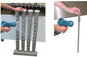
Reinigen Sie die Wasch- + Klarspülarne und deren Düsen. Zum Reinigen der Düsen, benutzen Sie eine Nylon Bürste. Überprüfen Sie die Wascharme und Endkappen auf Vollständigkeit und Dichtheit.
