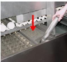
Überprüfen Sie ob alle Wascharme richtig fest sitzen. Überprüfen Sie alle Wascharme auf deren Vollständigkeit und richtige Position. Überprüfen Sie alle Wascharmendkappen auf Dichtheit. Setzen Sie die Ablaufstandrohre und Vorhänge wieder ein.
