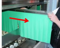
Entfernen Sie alle Spritzschutzvorhänge, und reinigen Sie diese.
