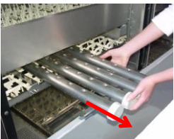
Retire los sistemas de lavado, brazos de clarado y los brazos de la bomba de aclarado.
