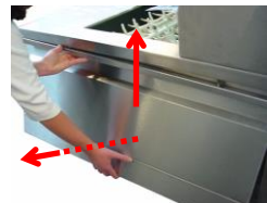
Retire las tapas de zona de la cinta transportadora en su entrada y salida.
