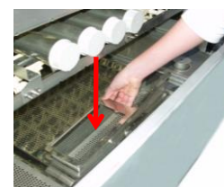
Cuando haya lavado el aparato, recolque todas las piezas; compruebe que están todas y que están en su correcta posición.
