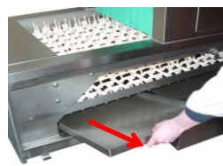
Retire las pantallas. Limpie completamente la zona de entrada y salida de la cinta transportadora utilizando una manguera.
