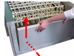
Retire las tapas de zona de la cinta transportadora en su entrada y salida.
