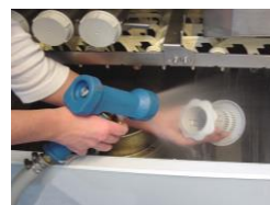
Retire y limpie el filtro del desagüe.
