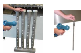
Limpie los brazos de lavado y aclarado y sus pulverizadores. Utilice cepillos de nylon. Compruebe que los tapones de los brazos están en su sitio y estancos.
