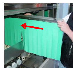
Compruebe que todos los brazos de lavado están bien colocados. Compruebe que los tapones de los brazos están en su sitio y estancos. Recolque los sistemas de lavado y cortinas.
