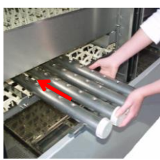
Compruebe que todos los brazos de lavado están bien colocados. Compruebe que los tapones de los brazos están en su sitio y estancos. Recolque los sistemas de lavado y cortinas.
