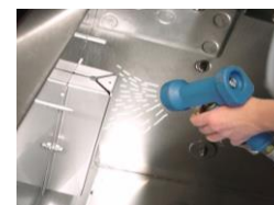
Limpie con chorro de agua el flotador del tanque.
