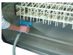
Retire las pantallas. Limpie completamente la zona de entrada y salida de la cinta transportadora utilizando una manguera.
