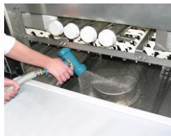
Limpie la cámara interior del tanque con una manguera.
