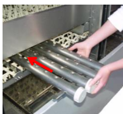
A conclusione della pulizia della macchina, reinserire nuovamente tutti i pezzi, verificando la presenza completa e il posizionamento corretto.
