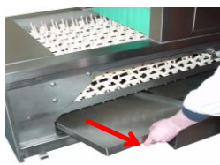
Estrarre i filtri. Pulire l'intero settore dell'entrata e dell'uscita con un flessibile d'acqua.
