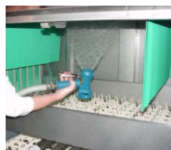
Sciappare l'interno della macchina e l'interno dello sportello con un flessibile.
