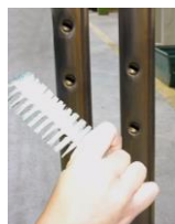
Pulire tutte le sfere di lavaggio + sfere di pre-risciacquo a pompa e gli ugelli. Per la pulizia degli ugelli, usare una spazzola di nylon. Verificare la completezza ed ermeticità delle sfere di lavaggio e cappucci.
