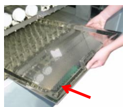
A conclusione della pulizia della macchina, reinserire nuovamente tutti i pezzi, verificando la presenza completa e il posizionamento corretto.
