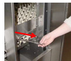
Estrarre i sistemi di lavaggio, sfere di risciacquo e le sfere di pre-risciacquo a pompa.
