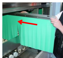
A conclusione della pulizia della macchina, reinserire nuovamente tutti i pezzi, verificando la presenza completa e il posizionamento corretto.
