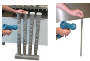
Pulire tutte le sfere di lavaggio + sfere di pre-risciacquo a pompa e gli ugelli. Per la pulizia degli ugelli, usare una spazzola di nylon. Verificare la completezza ed ermeticità delle sfere di lavaggio e cappucci.
