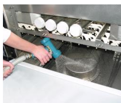
Sciappare l'interno della vasca con un flessibile.
