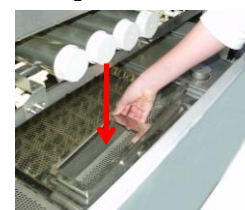
A conclusione della pulizia della macchina, reinserire nuovamente tutti i pezzi, verificando la presenza completa e il posizionamento corretto.
