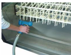
Estrarre i filtri. Pulire l'intero settore dell'entrata e dell'uscita con un flessibile d'acqua.
