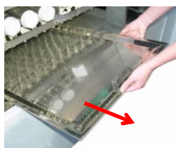
Estrarre la copertura vasca a filtro.
