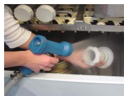
Estrarre il filtro dello scarico e pulirlo.
