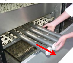
Estrarre i sistemi di lavaggio, sfere di risciacquo e le sfere di pre-risciacquo a pompa.
