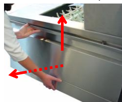
Estrarre tutti i rivestimenti dell'entrata e dell'uscita della macchina.
