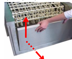
Estrarre tutti i rivestimenti dell'entrata e dell'uscita della macchina.
