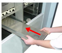
A conclusione della pulizia della macchina, reinserire nuovamente tutti i pezzi, verificando la presenza completa e il posizionamento corretto.
