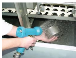
Pulire il filtro d'aspirazione della pompa.
