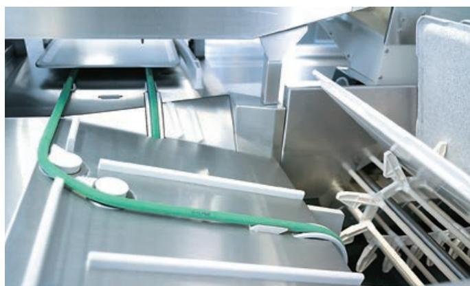
Wichtige Elemente der automatisierten Geschirrspülanlagen sind die automatische Tabletteintaktung und die automatische Besteckabnahme durch den Besteckabnehmermagnet.
