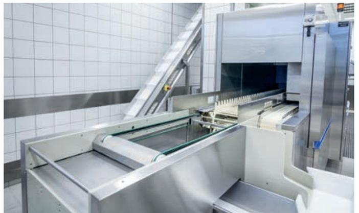
Das automatische Ab stapeln von Tablettts ist eine weitere Möglichkeit für die Automatisierung in der Spülküche. Dabei unterscheiden wir zwischen dem Ab stapeln der schmutzigen Tablettts als Zwischenpuffer und dem Ab stapeln der gespülten Tablettts zur Wiederbereitstellung im Speisesaal.
