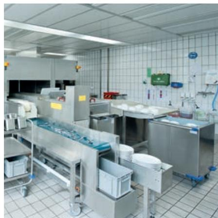
**Automatische Entladeeinrichtungen** Teller als Tellerstapel auf Förderband, Tablettts in Spenderwagen, Bestecke in Transportbehälter, Schalen (manuell) in Spenderwagen
