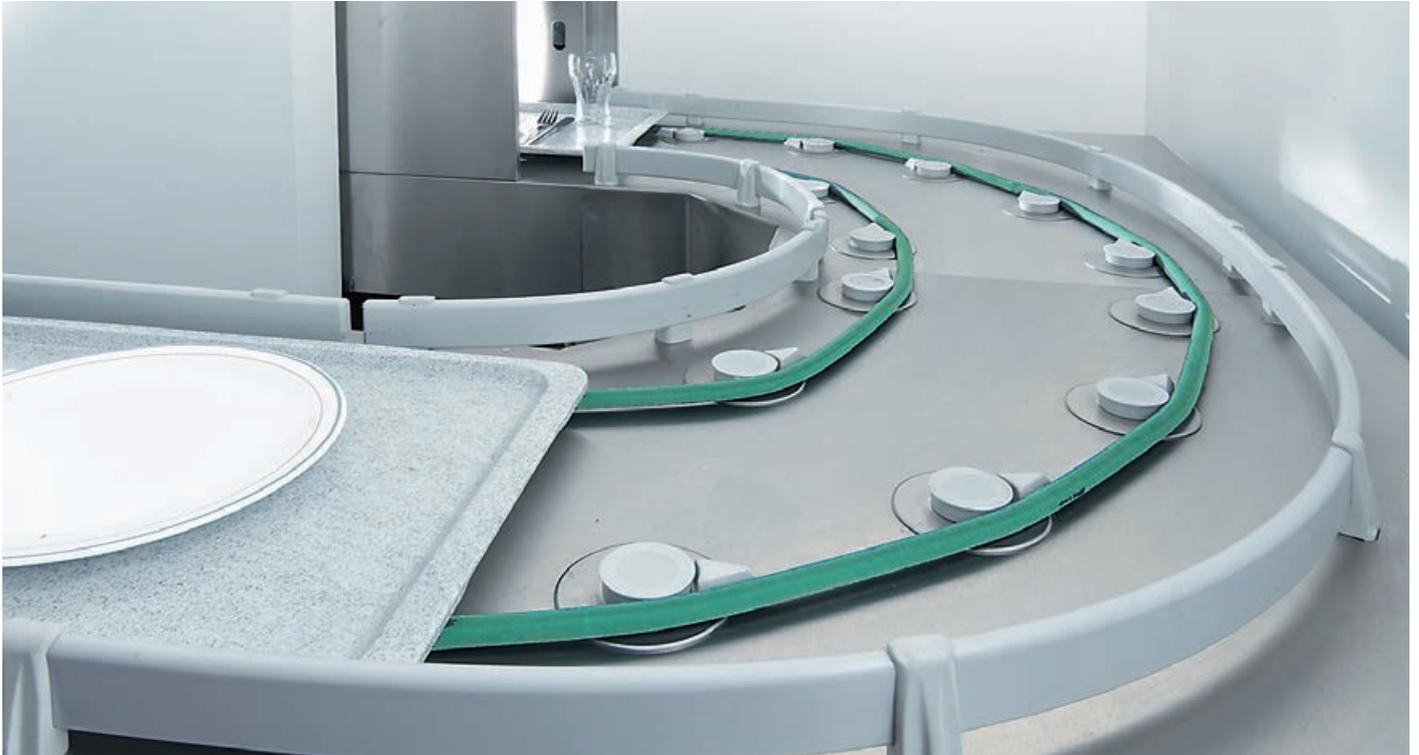
Mit der Rundriemenfördertechnik ist jede beliebige Kurve möglich. Durch Geschwindigkeitsunterschiede werden die Tablettts mit dem notwendigen Tablettabstand sicher und zentrisch um die Kurve befördert. Hohe und stabile Tablettführungen sorgen dafür, dass knapp aufgestellte Geschirrtelle durch die Kurvenfahrt nicht zu Boden fallen und die Tablettts sicher umgelenkt werden.
