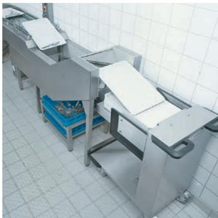
**Bestecktrennung ohne Besteck-abhebemagnet:** Durch das Abkippen der Tablettts fallen die Besteckteile in einen Besteckkorb. Die geleerten Tablettts werden durch ein ansteigendes Band zur Tablettstapeleinrichtung gefördert.
