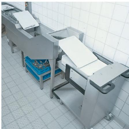
**Tri des couverts sans extracteur magnétique :** les plateaux sont inclinés de manière à déverser les couverts dans un panier. Une fois vidés, les plateaux sont transportés sur une bande ascendante jusqu'à l'empileur à plateaux.
