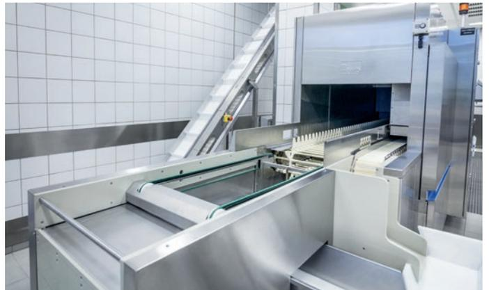
Le désempilage automatique des plateaux est une autre possibilité d'automatisation du travail dans l'arrière-cuisine. Il s'agit d'une part du désempilage des plateaux sales avant le lavage et de l'autre, de l'empilage des plateaux propres avant leur renvoi en salle.
