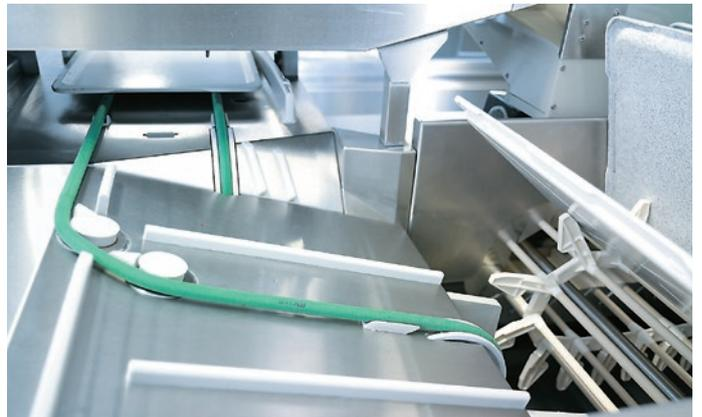
L'introduction automatique des plateaux et le tri automatique des couverts au moyen d'un extracteur magnétique sont des éléments importants de l'automatisation du processus de lavage.
