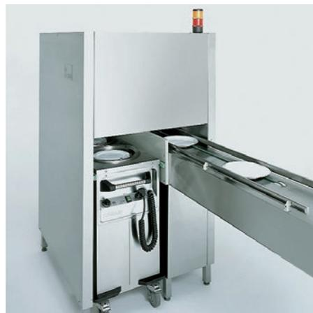
**Empileur d'assiettes TS 1800** – une solution rationnelle : l'empileur retire automatiquement les assiettes de la bande de transport et les dépose dans le distributeur d'assiettes.
