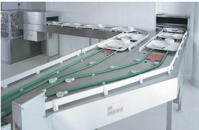
L'aiguillage multifonctions illustré ci-dessus peut être utilisé aux heures creuses ou durant l'entretien du lave-vaisselle pour faire converger les plateaux de deux voies pouvant transporter jusqu'à 2 x 30 plateaux/min. aux heures de pointe. Les plateaux poursuivent alors leur chemin sur la voie choisie, qui peut acheminer jusqu'à 30 plateaux/min. Dans ce cas, la quantité totale de plateaux transportés sur chacune des voies peut varier, mais ne peut dépasser 30 plateaux/min.
