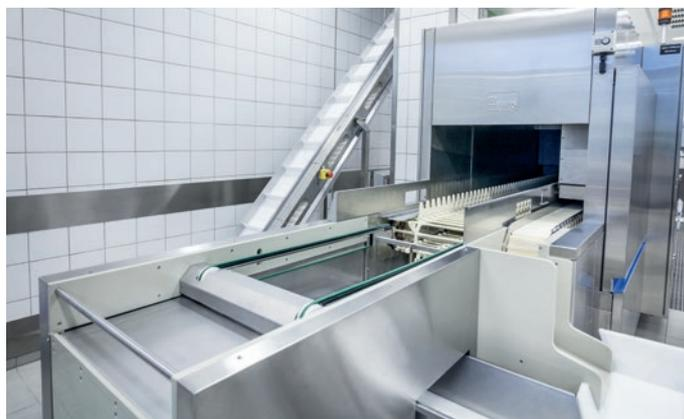
L'accatastamento automatico dei vassoi è un'ulteriore possibilità offerta per l'automatizzazione della zona di lavaggio. In questo caso occorre fare una distinzione tra l'accatastamento dei vassoi sporchi, una sorta di deposito provvisorio e l'accatastamento dei vassoi puliti che in questo modo possono essere pronti per un successivo utilizzo.
