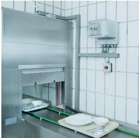
In presenza di una zona a potenziale rischio di incendio fra la zona di lavaggio e la sala pranzo, è necessario installare una barriera di protezione antincendio senza interrompere il percorso del trasportatore.
