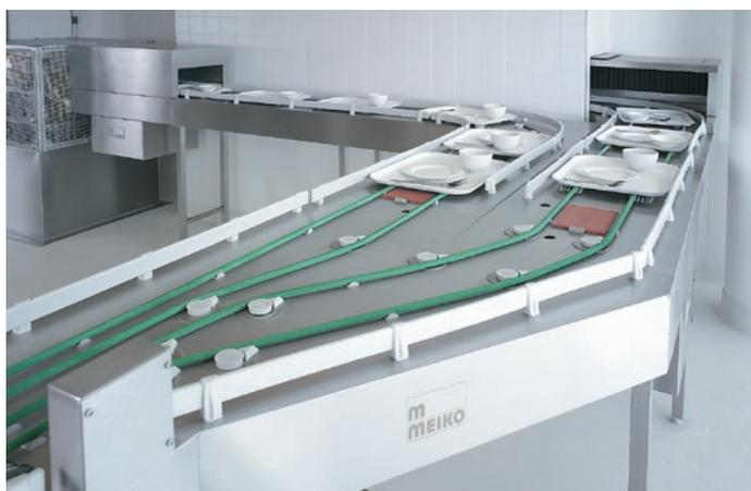
Grazie all'estrema versatilità dei sistemi di trasporto MEIKO è possibile inoltre smistare su un unico nastro due sezioni di trasporto con capacità massima di 30 vassoi / min. ciascuno, nel caso di flusso ridotto o operazioni di manutenzione. La capacità delle due piste può variare fino ad un totale complessivo di 30 vassoi.
