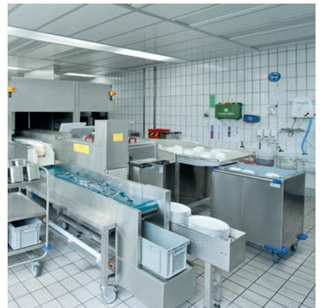
**Accatastatore di vassoi automatico a fine nastro di trasporto con tavola accatastastrice collegata.** Di volta in volta le pile di vassoi devono essere rimosse. E' un dispositivo utile in quelle situazioni in cui lo spazio disponibile non è sufficiente per operare con carrelli accatastatori.
