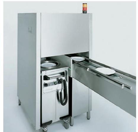
**L'accatastatore per piatti TS 1800:** un componente pratico per l'automazione. Preleva automaticamente i piatti dal nastro trasportatore e li impila in un carrello termico dispenser per piatti.
