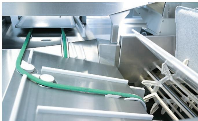
L'alimentazione automatica dei vassoi e il prelievo automatico delle posate mediante raccoglitore magnetico sono elementi importanti di un impianto automatico di lavaggio.
