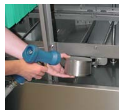
Enlevez les tuyaux de lavage et les bras de rinçage.
