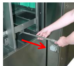
Enlevez les tuyaux de lavage et les bras de rinçage.
