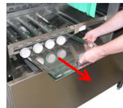
Enlevez les filtres de recouvrement du bac.
