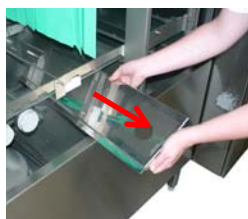
Enlevez les filtres de recouvrement du bac.
