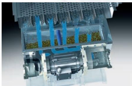
Nel corso del processo di lavaggio a funzionamento continuo, i residui di alimenti vengono filtrati da un filtro grossolano, quindi da un filtro fine autopulente.
