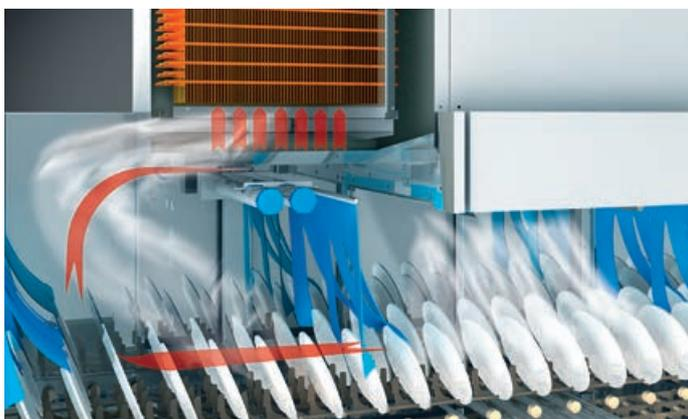
**Cool:** il flusso di calore viene deviato, fumi e vapore si raffreddano consentendo alla M-iQ di recuperare nuova energia di lavaggio.
