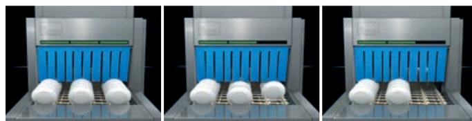
С помощью зеленого сигнала светофора M-iQ GreenCoach сигнализирует о том, какие дорожки на транспортере подачи посуды необходимо заполнить. Благодаря этому машина M-iQ работает в оптимальных условиях.
