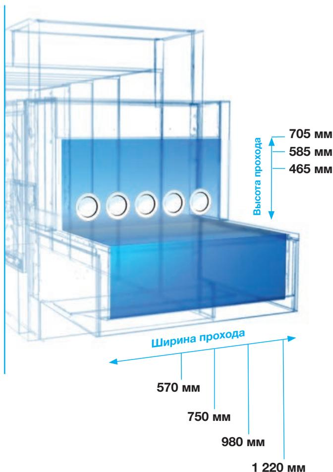
Благодаря различным вариантам ширины транспортера и прохода машина *M-iQ* идеально подходит под любые требования.
