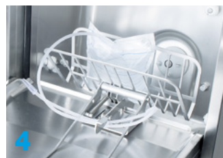
4. Deur sluiten, het snijden start automatisch
