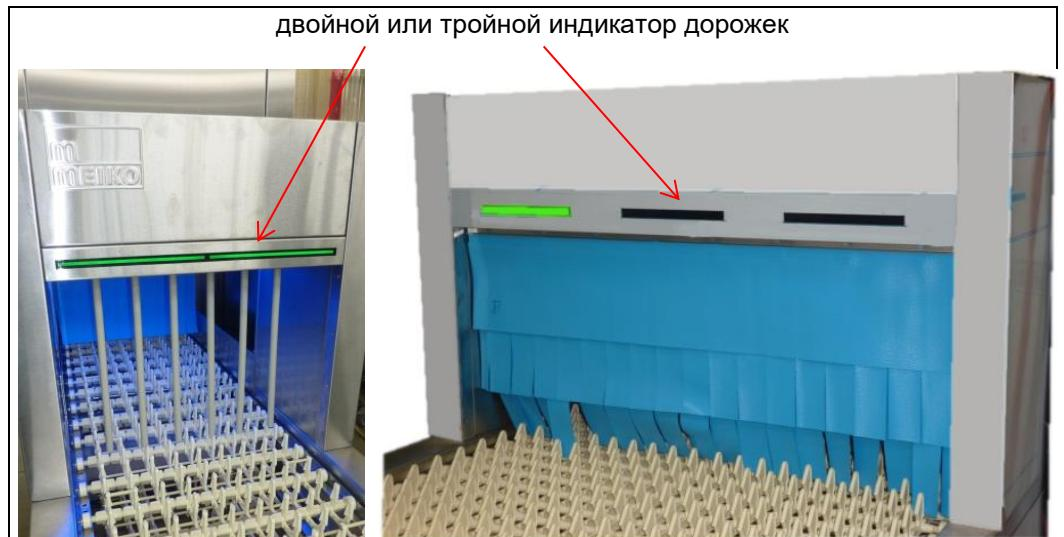
Более того, выполняется дополнительный „анализ“ пропусков. Зелёная световая полоса на входе машины сигнализирует моечному персоналу об оптимальной загрузке дорожек или ленты и о необходимости загружать посуду лишь на отдельные участки (дорожки) конвейерной ленты вследствие незначительной загрузки машины. Данный режим работы позволяет достичь снижения расхода свежей воды и ополаскивателя примерно на 50%.
