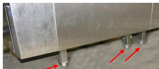
Для регулировки опор машины необходим гаечный ключ на 27 мм!
