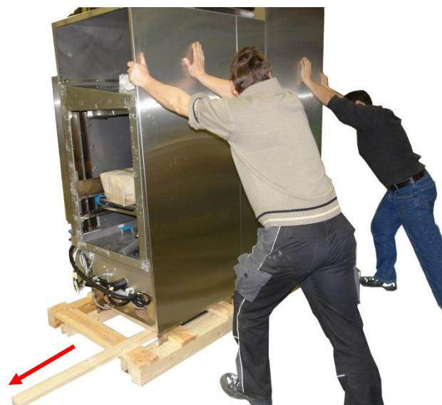
Рассоединив все резьбовые соединения транспортной упаковки, приподнять машину с одной стороны, теперь можно без усилий извлечь из-под машины все большие продольные балки.
