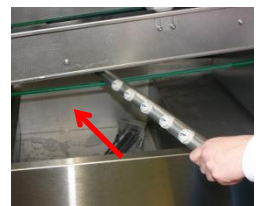
Überprüfen Sie ob alle Wascharme richtig fest sitzen. Überprüfen Sie alle Wascharme auf deren Vollständigkeit und richtige Position. Überprüfen Sie alle Wascharmendkappen auf Dichtheit. Setzen Sie das Ablaufstandrohr und Vorhänge wieder ein.
