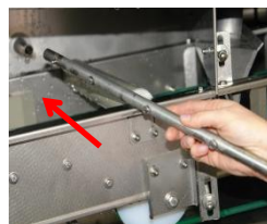
Überprüfen Sie ob alle Wascharme richtig fest sitzen. Überprüfen Sie alle Wascharme auf deren Vollständigkeit und richtige Position. Überprüfen Sie alle Wascharmendkappen auf Dichtheit. Setzen Sie das Ablaufstandrohr und Vorhänge wieder ein.
