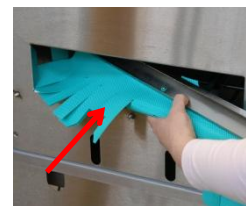
Überprüfen Sie ob alle Wascharme richtig fest sitzen. Überprüfen Sie alle Wascharme auf deren Vollständigkeit und richtige Position. Überprüfen Sie alle Wascharmendkappen auf Dichtheit. Setzen Sie das Ablaufstandrohr und Vorhänge wieder ein.
