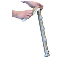
Reinigen Sie Die Wasch- + Klarspülarne und deren Düsen. Zum Reinigen der Düsen, benutzen Sie eine Nylon Bürste. Überprüfen Sie die Wascharme und Endkappen auf Vollständigkeit und Dichtheit.
