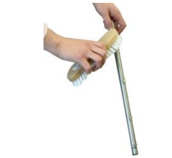
Reinigen Sie Die Wasch- + Klarspülarne und deren Düsen. Zum Reinigen der Düsen, benutzen Sie eine Nylon Bürste. Überprüfen Sie die Wascharme und Endkappen auf Vollständigkeit und Dichtheit.
