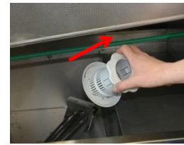
Entfernen Sie den Ablaufsieb, und reinigen Sie diesen.
