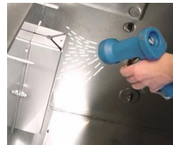
Schwimmer der Tankfüllung abspritzen.
