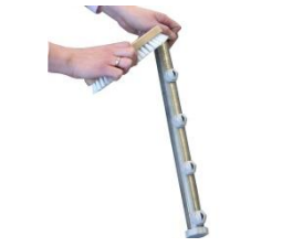
Limpie los brazos de lavado y aclarado y sus pulverizadores. Utilice cepillos de nylon. Compruebe que los tapones de los brazos están en su sitio y estancos.
