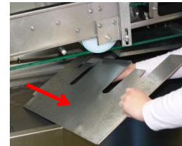
Quite las chapas de mamparo.
