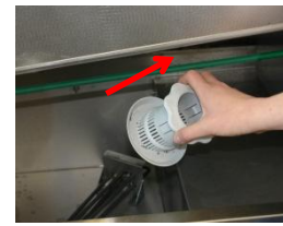
Retire y limpie el filtro del desagüe.
