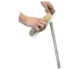
Limpie los brazos de lavado y aclarado y sus pulverizadores. Utilice cepillos de nylon. Compruebe que los tapones de los brazos están en su sitio y estancos.
