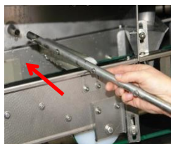
Compruebe que todos los brazos de lavado están bien colocados. Compruebe que los tapones de los brazos están en su sitio y estancos. Recolecte los sistemas de lavado y cortinas. Recolecte los sistemas de lavado y cortinas.
