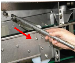
Retire los sistemas de lavado inferiores / superiores, brazos de clarado y los brazos de la bomba de aclarado.
