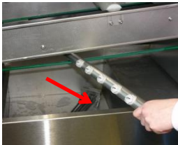
Retire los sistemas de lavado inferiores / superiores, brazos de clarado y los brazos de la bomba de aclarado.
