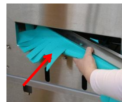
Compruebe que todos los brazos de lavado están bien colocados. Compruebe que los tapones de los brazos están en su sitio y estancos. Recolecte los sistemas de lavado y cortinas. Recolecte los sistemas de lavado y cortinas.
