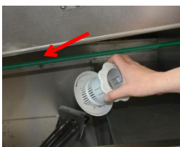
Cuando haya lavado el aparato, recoleque todas las piezas; compruebe que están todas y que están en su correcta posición.
