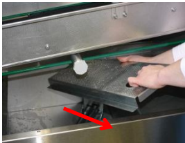
Retire los soportes de pantalla.
