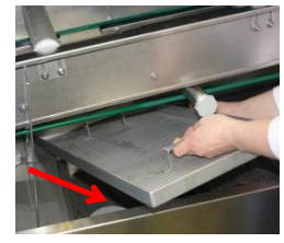
Retire las pantallas cubre tanque.
