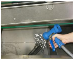
Limpie la cámara interior del tanque con una manguera.
