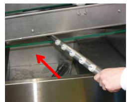
Compruebe que todos los brazos de lavado están bien colocados. Compruebe que los tapones de los brazos están en su sitio y estancos. Recolecte los sistemas de lavado y cortinas. Recolecte los sistemas de lavado y cortinas.
