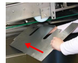
Cuando haya lavado el aparato, recoleque todas las piezas; compruebe que están todas y que están en su correcta posición.
