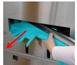
Retire y limpie las cortinas de protección.
