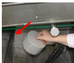
Cuando haya lavado el aparato, recoleque todas las piezas; compruebe que están todas y que están en su correcta posición.
