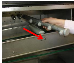
Retire los sistemas de lavado inferiores / superiores, brazos de clarado y los brazos de la bomba de aclarado.
