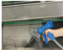
Nettoyez l'intérieur du bac avec un tuyau.
