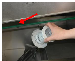
Après avoir nettoyé la machine, réinstallez toutes les parties et vérifiez leur intégralité et leur position correcte.
