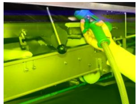
Ouvrez la tôle de fond de l'aspiration et nettoyez-la.
