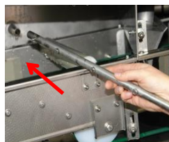
Vérifiez que tous les bras de lavage sont fermement mis en place. Vérifiez l'intégralité et la position correcte des bras de lavage. Vérifiez l'étanchéité de tous les capuchons d'extrémité des bras de lavage. Réinstallez les trop-pleins de vidange et les rideaux.
