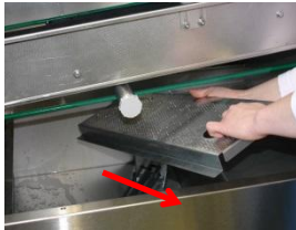
Enlevez les supports des filtres de recouvrement
