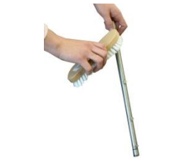
Nettoyez les tuyaux de lavage et de rinçage et leurs gicleurs. Utilisez une brosse en nylon pour nettoyer les gicleurs. Vérifiez l'intégralité et l'étanchéité des tuyaux de lavage et des capuchons d'extrémité.
