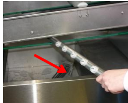
Enlevez les systèmes de lavage, les bras de rinçage et les bras de rinçage alimentés par la pompe.
