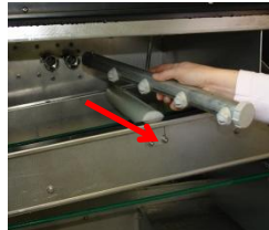
Enlevez les systèmes de lavage, les bras de rinçage et les bras de rinçage alimentés par la pompe.
