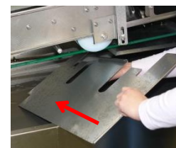
Après avoir nettoyé la machine, réinstallez toutes les parties et vérifiez leur intégralité et leur position correcte.
