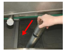
Vérifiez que tous les bras de lavage sont fermement mis en place. Vérifiez l'intégralité et la position correcte des bras de lavage. Vérifiez l'étanchéité de tous les capuchons d'extrémité des bras de lavage. Réinstallez les trop-pleins de vidange et les rideaux.
