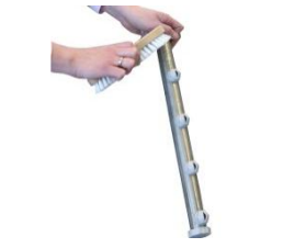
Nettoyez les tuyaux de lavage et de rinçage et leurs gicleurs. Utilisez une brosse en nylon pour nettoyer les gicleurs. Vérifiez l'intégralité et l'étanchéité des tuyaux de lavage et des capuchons d'extrémité.
