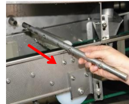
Enlevez les systèmes de lavage, les bras de rinçage et les bras de rinçage alimentés par la pompe.
