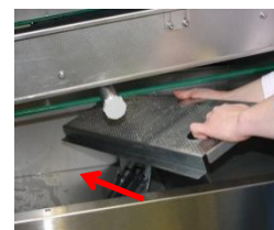
Après avoir nettoyé la machine, réinstallez toutes les parties et vérifiez leur intégralité et leur position correcte.
