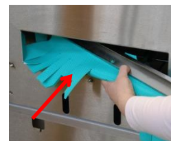
Vérifiez que tous les bras de lavage sont fermement mis en place. Vérifiez l'intégralité et la position correcte des bras de lavage. Vérifiez l'étanchéité de tous les capuchons d'extrémité des bras de lavage. Réinstallez les trop-pleins de vidange et les rideaux.
