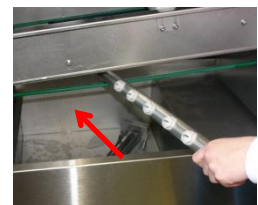
Vérifiez que tous les bras de lavage sont fermement mis en place. Vérifiez l'intégralité et la position correcte des bras de lavage. Vérifiez l'étanchéité de tous les capuchons d'extrémité des bras de lavage. Réinstallez les trop-pleins de vidange et les rideaux.
