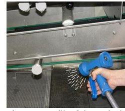
Aspergez l'intérieur de la machine.
