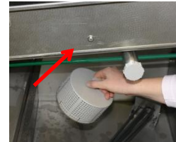
Estrarre il filtro d'aspirazione della pompa e pulirlo.
