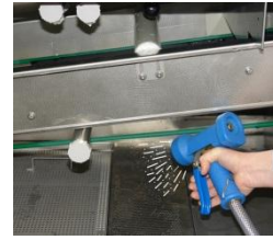
Sciacquare l'interno della macchina con un flessibile.
