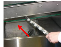
Verificare il fissaggio fermo delle sfere di lavaggio. Verificare la presenza completa e il posizionamento corretto delle sfere di lavaggio. Verificare l'ermeticità di tutti i cappucci delle sfere di lavaggio. Rimettere gli scarichi e le tendine paraspruzzi al giusto posto.
