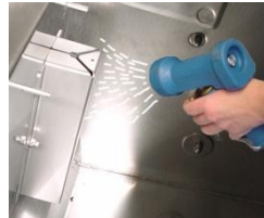
Sciacquare il galleggiante del riempimento della vasca.
