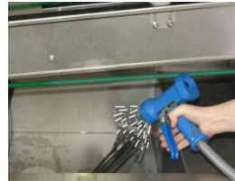
Sciacquare l'interno della vasca con un flessibile.
