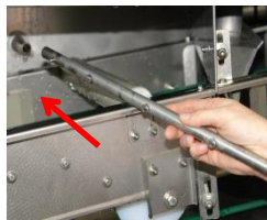
Verificare il fissaggio fermo delle sfere di lavaggio. Verificare la presenza completa e il posizionamento corretto delle sfere di lavaggio. Verificare l'ermeticità di tutti i cappucci delle sfere di lavaggio. Rimettere gli scarichi e le tendine paraspruzzi al giusto posto.
