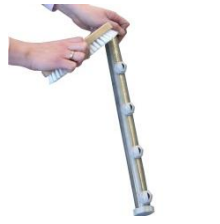
Pulire tutte le sfere di lavaggio + sfere di risciacquo e gli ugelli. Per la pulizia degli ugelli, usare una spazzola di nylon. Verificare la completezza ed ermeticità delle sfere di lavaggio e cappucci.
