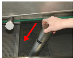
Verificare il fissaggio fermo delle sfere di lavaggio. Verificare la presenza completa e il posizionamento corretto delle sfere di lavaggio. Verificare l'ermeticità di tutti i cappucci delle sfere di lavaggio. Rimettere gli scarichi e le tendine paraspruzzi al giusto posto.
