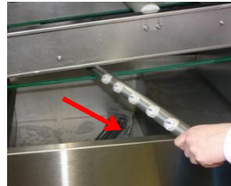
Estrarre i sistemi di lavaggio sotto/sopra e le sfere di risciacquo.
