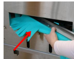
Verificare il fissaggio fermo delle sfere di lavaggio. Verificare la presenza completa e il posizionamento corretto delle sfere di lavaggio. Verificare l'ermeticità di tutti i cappucci delle sfere di lavaggio. Rimettere gli scarichi e le tendine paraspruzzi al giusto posto.
