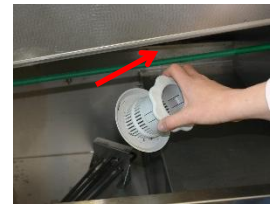
Verwijder de afvoerzeef en reinig hem.
