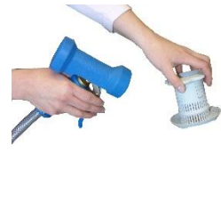
Verwijder de afvoerzeef en de pompaanzuigzeef.
