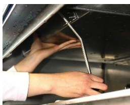
Sluit de bodembak aan de afzuiging aan.
