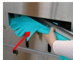
Controleer of alle wasarmen goed vast zitten. Controleer alle wasarmen op volledigheid en juiste positie. Controleer alle eindkappen van de wasarmen op dichtheid. Plaats de staande afvoerbuizen en gordijnen weer.
