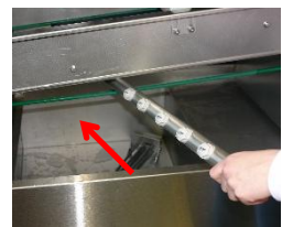
Controleer of alle wasarmen goed vast zitten. Controleer alle wasarmen op volledigheid en juiste positie. Controleer alle eindkappen van de wasarmen op dichtheid. Plaats de staande afvoerbuizen en gordijnen weer.
