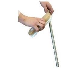
Reinig de was- + glansspoelarmen en de sproeiers. Gebruik voor het reinigen van de sproeiers een nylonborstel. Controleer de wasarmen en eindkappen op volledigheid en dichtheid.
