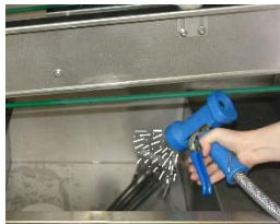
Reinig het inwendige van de tank met een waterslang.
