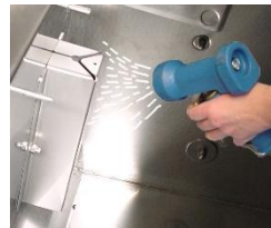
Vlonder van de tankvulling afspreien.
