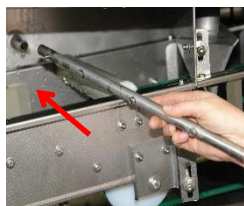
Controleer of alle wasarmen goed vast zitten. Controleer alle wasarmen op volledigheid en juiste positie. Controleer alle eindkappen van de wasarmen op dichtheid. Plaats de staande afvoerbuizen en gordijnen weer.
