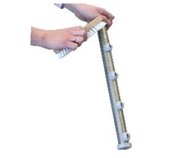
Reinig de was- + glansspoelarmen en de sproeiers. Gebruik voor het reinigen van de sproeiers een nylonborstel. Controleer de wasarmen en eindkappen op volledigheid en dichtheid.
