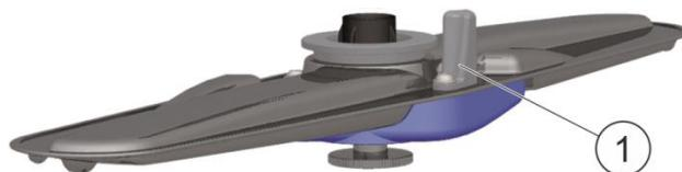
5. Affinché il sensore possa riconoscere la rotazione del braccio di lavaggio, è necessario rimuovere tutte le particelle di sporco e contenenti ferro che aderiscono al magnete (1).
