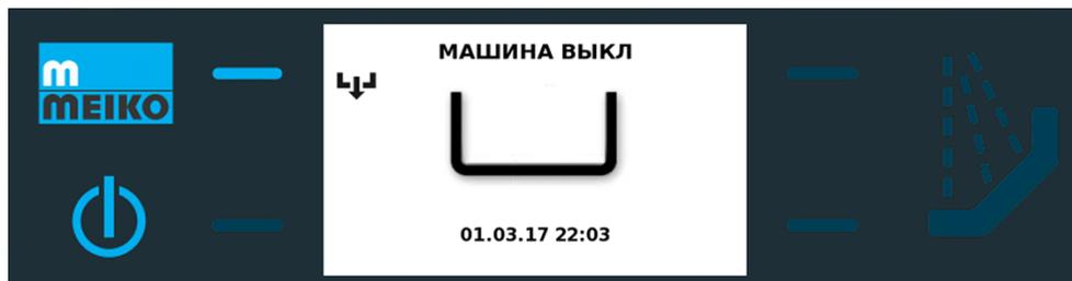
➔ По окончании процесса посудомоечная машина автоматически переключается в режим **МАШИНА ВЫКЛ.**
