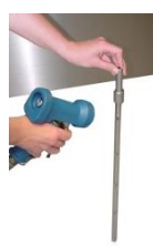
Nettoyez les tuyaux de lavage et de rinçage et leurs gicleurs. Utilisez une brosse en nylon pour nettoyer les gicleurs. Vérifiez l'intégralité et l'étanchéité des tuyaux de lavage et des capuchons d'extrémité.
