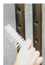
Nettoyez les tuyaux de lavage et de rinçage et leurs gicleurs. Utilisez une brosse en nylon pour nettoyer les gicleurs. Vérifiez l'intégralité et l'étanchéité des tuyaux de lavage et des capuchons d'extrémité.
