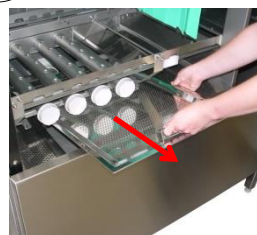
Enlevez les filtres de recouvrement du bac
