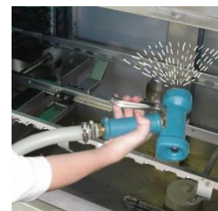
Reinigen Sie den kompletten Tankinnenraum mit einem Wasserschlauch
