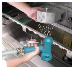
Nettoyez le filtre d'aspiration de la pompe.
