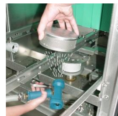
Nettoyez le filtre d'aspiration de la pompe.
