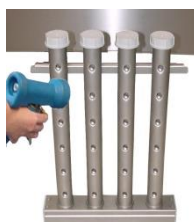
Nettoyez les tuyaux de lavage et de rinçage et leurs gicleurs. Utilisez une brosse en nylon pour nettoyer les gicleurs. Vérifiez l'intégralité et l'étanchéité des tuyaux de lavage et des capuchons d'extrémité.
