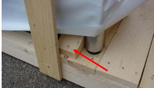
z.B.: diese und weitere Schrauben entfernen!
