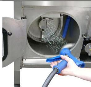
15. Sciacquare accuratamente l'unità della triturazione (angoli superiori frontale) con un tubo d'acqua.
