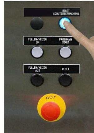
Nach dem Beladen der Anlage mit Spülgut und dem Schließen der Türen drücken Sie die Taste **“RESET TÜRÜBERWACHUNG“**.
