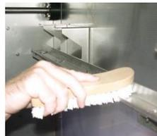
Reinigen Sie die Laufschiene des Waschsystems.
