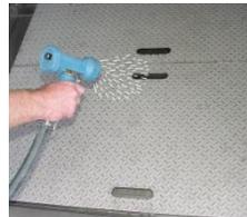
Reinigen Sie die Trittleche mit einem Wasserschlauch.
