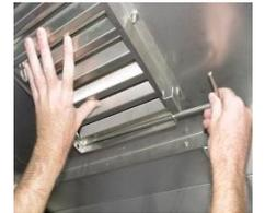
Entfernen Sie den Kondensatsabscheider.
