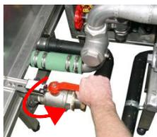
Nachdem Sie die Teile eingesetzt haben, schließen sie nun die geöffneten Ablassventile.
