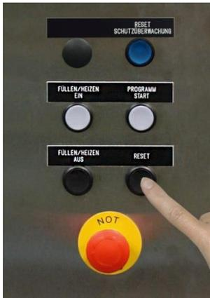
Bei Unterbrechung, drücken Sie die Taste **“RESET“**. Die Maschine bleibt betriebsbereit.
