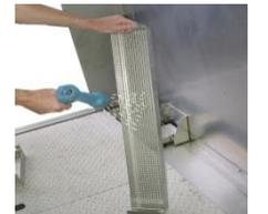
Reinigen Sie die seitlichen Siebkörbe.
