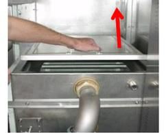
Entfernen Sie die Abdeckung am Waschtank.
