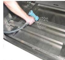
Reinigen Sie den Waschkammerinnenraum mit einem Wasserschlauch.
