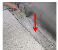
Reinigen Sie die Trittbleche mit einem Wasserschlauch.
