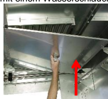
Reinigen Sie den Washkammerinnenraum mit einem Wasserschlauch.
