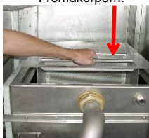
Überprüfen Sie die Ansaugöffnung nach Fremdkörpern.
