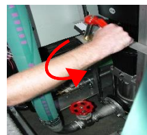
Nachdem Sie die Teile eingesetzt haben, schließen sie nun die geöffneten Ablasventile.
