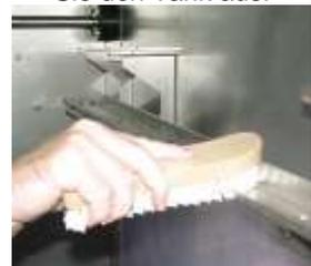
Reinigen Sie die Laufschiene des Waschsystems.
