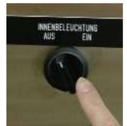
Die Innenbeleuchtung muss mit dem Knebschalter separat ausgeschaltet werden.
