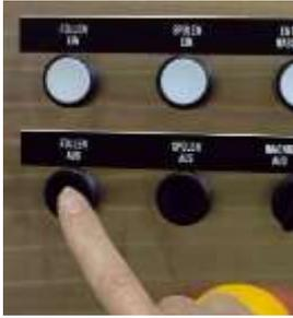
Drücken Sie die Taste „FÜLLEN AUS“. Die Rolltore fahren nach oben, die Kipp-Hebevorrichtung nach unten.
