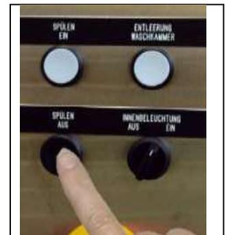
Bei Unterbrechung drücken Sie die Taste "SPÜLEN AUS". Die Maschine bleibt betriebsbereit
