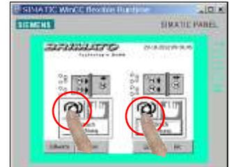
Den Automatikbetrieb durch aufeinander folgendes Betätigen der gekennzeichneten Symbole starten (Touchpanel FT-Einlauf)
