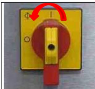
Schalten Sie den Hauptschalter am Elektroschaltkasten aus.
