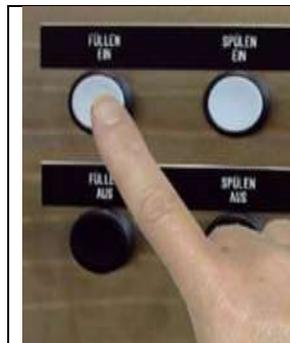
Drücken Sie die Taste "FÜLLEN EIN". (Taste blinkt langsam)
