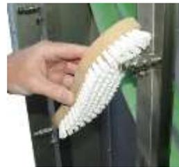
Reinigen Sie die kompletten Düsen mit einer Nylonbürste.
