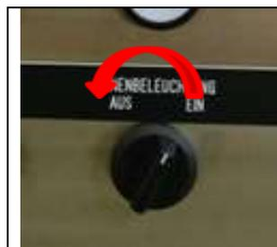
Die Innenbeleuchtung muss mit dem Knebelschalter „INNENBELEUCHUNG AUS/EIN“ separat ausgeschaltet werden
