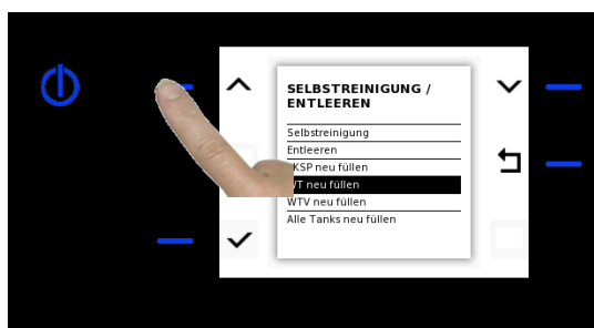
Zbiornik płukania pompy jest opróżniany i ponownie napełniany.
