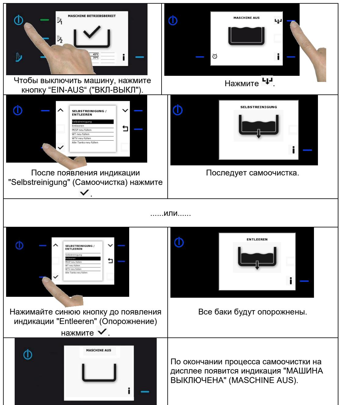
**Для промежуточного, частичного или полного опорожнения с последующим автоматическим наполнением всего бака возможны следующие опции:**
