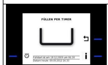
Теперь на дисплее отображается время начала заполнения по таймеру ("Füllen per Timer"). Если указано правильное время, то можно оставить машину в этом состоянии.
