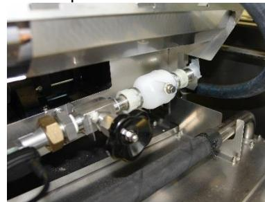
Здесь, на смесительной камере, находится точка подключения к линии подачи ополаскивателя.
