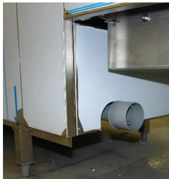
Все водяные стоки машины следует подключить с канализационной сети кухни через достаточно большие сифонные затворы.
