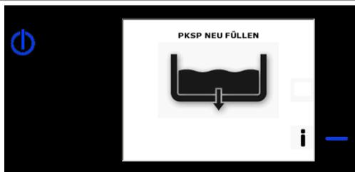
Der Pumpenklarspültank wird entleert und neu gefüllt.
