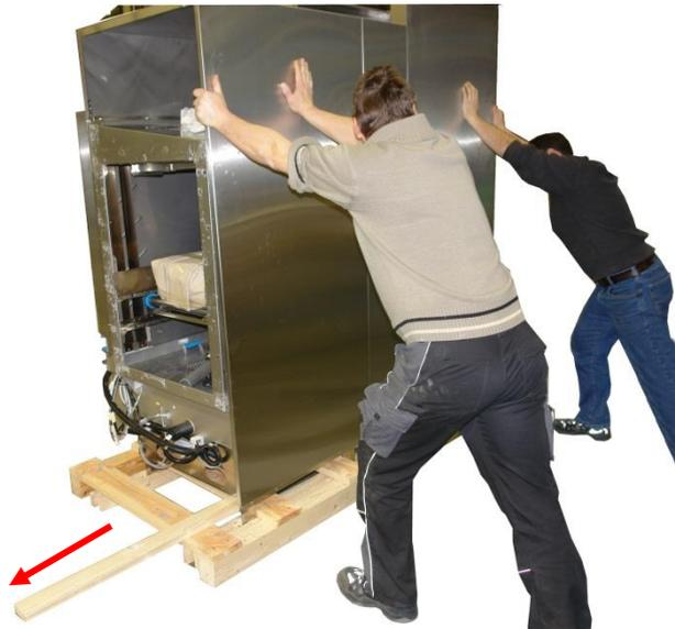
Sind alle Verschraubungen der Transportverpackungen gelöst, wird die Maschine einseitig angehoben und alle großen Längsbalken können nun ohne Kraftanstrengung unter der Maschine herausgezogen werden.
