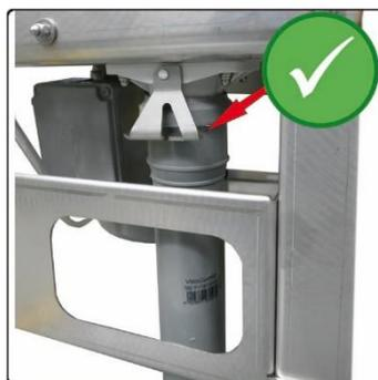
Alle Wasserabläufe der Maschine sind über einen ausreichend großen Geruchsverschluss an das Abwassernetz der Küche anzuschließen.
