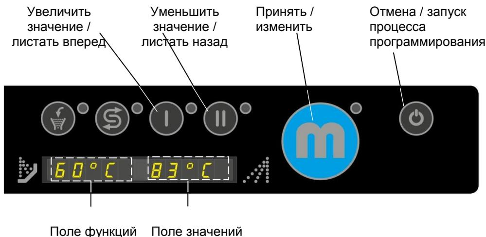
Разным пользовательским уровням соответствуют различные коды доступа. После окончания ввода заданный код сопоставляется с данными встроенной таблицы кодов. В зависимости от введенного кода выполняется переход к соответствующему пользовательскому уровню.
