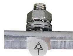
La vis pour la compensation de potentiel se trouve derrière le panneau de revêtement sur la face frontale de la machine.
