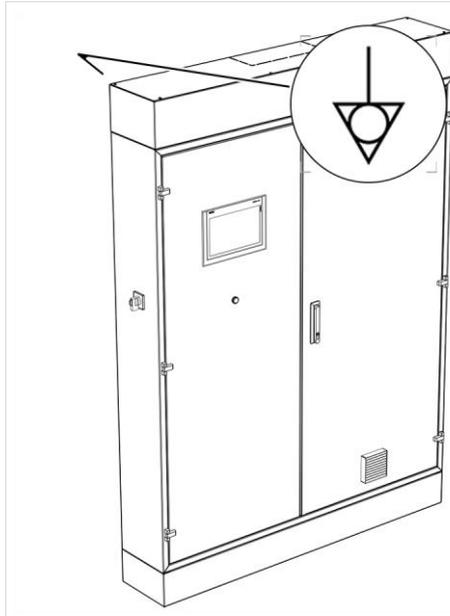
Schutzpotentialausgleich an der Schaltschrank-Oberseite. Ggf. können weitere Anschlüsse für einen Schutzpotentialausgleich an der Rundriemen-Förderanlage vorhanden sein. Siehe Montageplan. (Abbildung beispielhaft)
