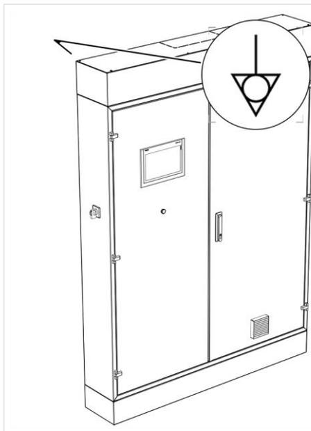
Compensation du potentiel de protection sur la partie supérieure de l'armoire électrique. Le cas échéant, d'autres raccordements pour une compensation de potentiel de protection peuvent être disponibles sur le convoyeur polycorde. Voir le plan de montage. (figure à titre d'exemple)
