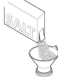
1. Otvorite poklopac objema rukama, spremnik za otapanje soli nadopunite s 2,2 kg regeneracijske soli (natrijev klorid veličine zrna od 0,3 – 1 mm). Po mogućnosti se služite lijevkom!
