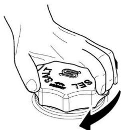
2. Очистите уплотнитель и резьбу бака для соли и плотно закройте её. Попадание воды может привести к снижению эффективности водоумягчителя!
