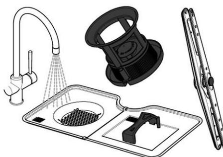
2. Выньте защитную решетку бака, фильтр, системы мойки сверху и снизу. Все подлежащие очистке детали синего цвета, или имеют синюю ручку.
