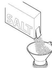
1. Tür öffnen, Salzlösebehälter öffnen und mit 1,5 kg Regeneriersalz (Natriumchlorid mit einer Korngröße von 0,3 –1 mm) befüllen. Nach Möglichkeit Trichter verwenden!
