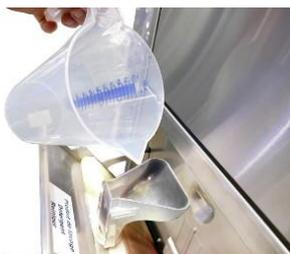
3. Chemie mit Hilfe des Trichters vorsichtig in die Maschine füllen, bis der Vorratsbehälter voll ist. Füllstand von außen kontrollieren.
