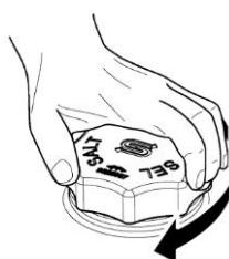
2. Očistite brtvu i navoj na otvoru spremnika za otapanje soli pa ga dobro zatvorite. Prodiranjem vode za pranje može smanjiti kapacitet uređaja za omešivanje vode!
