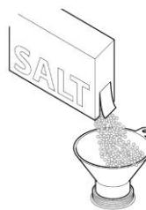
1. Otvorite vrata, otvorite spremnik za otapanje soli i napunite ga s 1,5 kg regeneracijske soli (natrijev klorid s veličinom zrna od 0,3 – 1 mm). Po mogućnosti se služite lijevkom!
