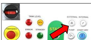
4. Drücken Sie den weißen Taster PUMP. Halten Sie ihn gedrückt, bis der Trichter vollständig entleert ist.
