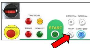
1. Drücken Sie den weißen Taster PUMP. Halten Sie ihn gedrückt, bis der Trichter vollständig entleert ist.
