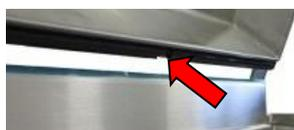
13. Prüfen Sie den Vakuum-Belüftungs-Spalt im hinteren Bereich der Deckeldichtung. Der Spalt muss mindestens 2 cm breit sein. Verschieben Sie bei Bedarf die Dichtung beidseitig von Hand, bis ein 2 cm breiter Spalt entsteht.
