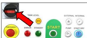
1. Schalten Sie den BioMaster® an der elektrischen Netztrenneinrichtung aus - Stellung OFF.
