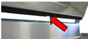
13. Vérifiez l'espace de ventilation à vide à l'arrière du joint de couvercle. L'espace doit être d'au moins 2 cm. Si nécessaire, déplacez le joint à la main des deux côtés jusqu'à ce qu'il y ait un espace de 2 cm.
