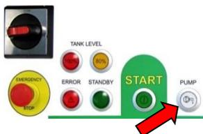
1. Drücken Sie den weißen Taster PUMP. Halten Sie ihn gedrückt, bis der Trichter vollständig entleert ist.
