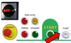
11. Drücken Sie den weißen Taster PUMP. Halten Sie ihn gedrückt, bis der Trichter vollständig entleert ist.
