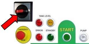
2. Schalten Sie den BioMaster® an der elektrischen Netztrenneinrichtung aus - Stellung OFF.
