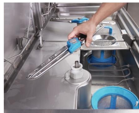
Le concept efficacité bleue : Visualisation des pièces à atteindre par l'opérateur pour les manipulations de nettoyage. Détection lors du repositionnement des éléments afin d'assurer le bon fonctionnement de la machine.
