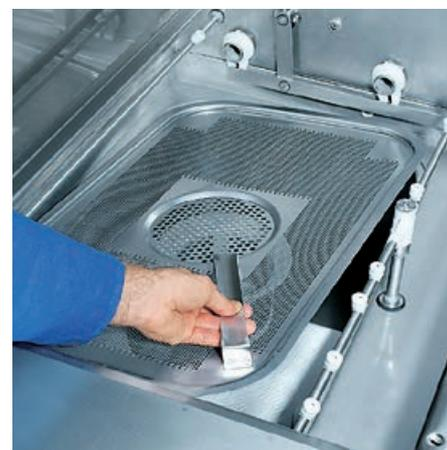
**Tamiz de cubierta del tanque**
