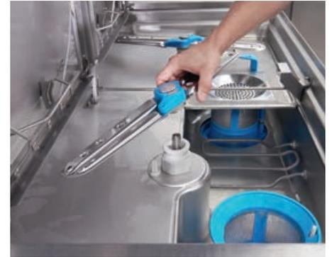
El concepto de manejo azul: todo lo que esté marcado en azul puede ser retirado, limpiado y colocado de nuevo. El *M-iClean H* comprueba automáticamente si se ha colocado todo correctamente.
