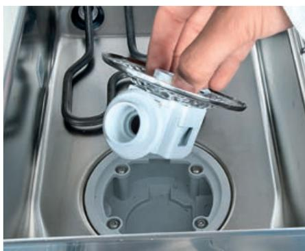
A la bomba de desagüe del *M-iClean U* se accede fácilmente desde el interior, lo que permite sacar rápidamente cualquier cuerpo extraño y continuar con el proceso de lavado sin ningún problema.
