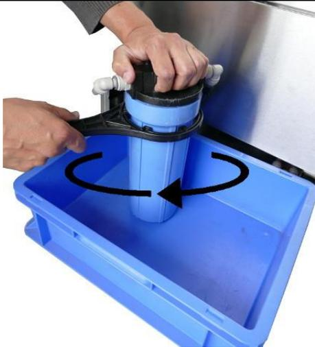
1. Dévisser le carter en tournant la clé dans le sens horaire. Installer un bac récepteur sous la machine !
