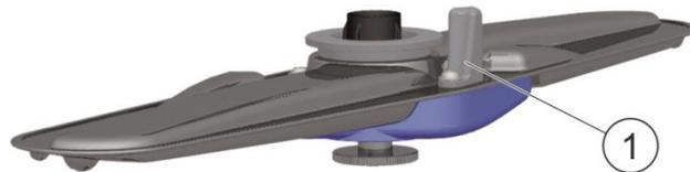
5. Pour que le capteur détecte la rotation du bras de rinçage, retirer toutes les particules de salissures et les particules ferreuses qui collent sur les aimants (1).
