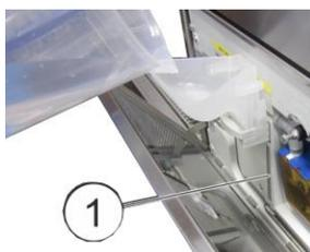
5. Verser avec précaution le produit chimique dans la machine en utilisant un entonnoir, jusqu'à ce que le réservoir de stockage soit plein. Contrôler le niveau de remplissage via la fenêtre de niveau (1).
