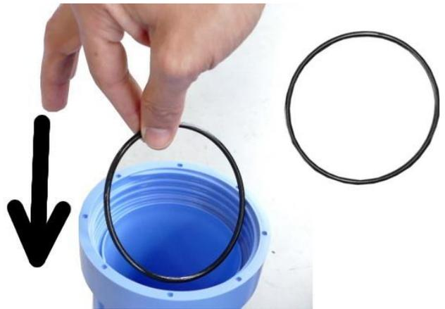
4. Remplacer l'ancienne bague d'étanchéité.
