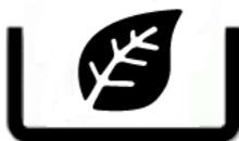
Pendant les temps d'arrêt (pauses), la machine indique par le symbole d'une feuille que de l'énergie est économisée et que les pièces sont ménagées.
