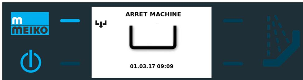
➡ Le lave-vaisselle passe automatiquement en mode **ARRÊT MACHINE** à la fin de l'opération.
