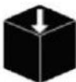
Lorsque l'opérateur appuie sur la touche de confirmation correspondante, en haut à droite, le symbole **Fermer capot** s'affiche à l'écran et l'opérateur a alors 10 secondes pour fermer le capot sans que le programme démarre. Il est ensuite nécessaire d'appuyer à nouveau sur la touche. Il peut être nécessaire d'interrompre auparavant l'exécution des sessions du menu d'information, avec la touche d'accès au service, voir page 49.
