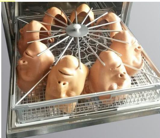
Für die Masken sind speziell abgestimmte Körbe vorgesehen. Die Masken und die Kleinteile entsprechend der dafür vorgesehenen Lage in den Korb einsetzen.
