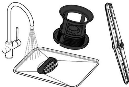
2. Retirer le filtre fond de cuve, le filtre et les systèmes de lavage supérieur et inférieur. Toutes les pièces à nettoyer sont bleues ou ont une poignée bleue.
