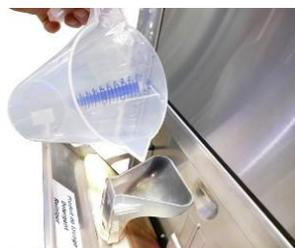
3. Verser avec précaution le produit chimique dans la machine en utilisant la trémie d'alimentation, jusqu'à ce que le réservoir de stockage soit plein. Surveiller le niveau de remplissage de l'extérieur.
