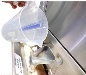
3. Versare le sostanze chimiche nella macchina, prestando attenzione e con l'aiuto di un imbuto, fino a quando il contenitore di riserva non è pieno. Controllare il livello di riempimento dall'esterno.
