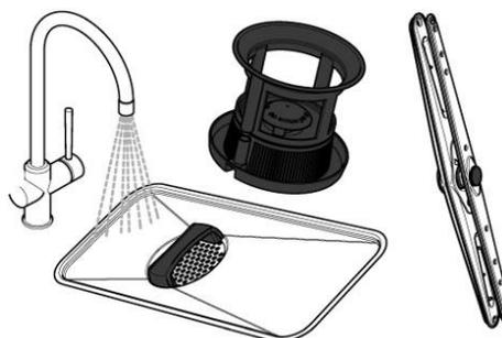
2. タンクカバー網、フィルター、上下の洗浄システムを取り外します。洗浄する部品は色が青であるか、青いハンドルが付いています。
