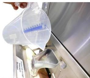
3. 漏斗を使用し、ケミカルが機械のストック容器に一杯になるまで、慎重に満たします。充填レベルを外から確認します。
