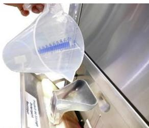
3. 使用漏斗小心地将化学制品注入机器中，直到储存罐装满。从外部检查料位。
