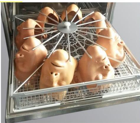
这类防毒面罩应使用专门设计的篮筐。将防毒面罩和小件洗涤物品放入篮中规定的位置。
